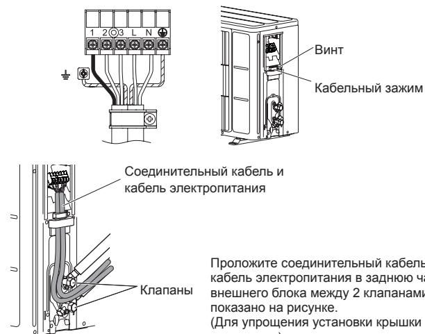
Проложите соединительный кабель и кабель электропитания в заднюю часть внешнего блока между 2 клапанами, как показано на рисунке.
